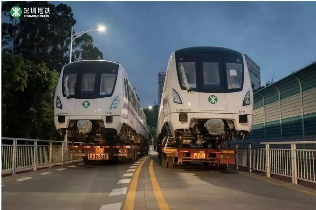
据了解，5号线南延段采用国内主流A型车，每列编组6个车厢，每节车厢长约22米~24米、宽3.1米、高3.8米。据悉，列车设计时速80公里，最大载客量2502人。首列车到达深云车辆段后，将进行组装、调试，与各种设备进行磨合。按照计划，5号线南延段其余地铁车辆将以每月2列车的速度分批运抵车辆段进行调试，为试运营做准备。深圳地铁5号线南延段计划于今年9月30日开通试运营，开通后的5号线，将和地铁2号线、9号线西延段换乘，并无缝接驳深惠城际铁路。
